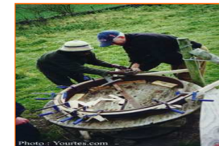
Moulage d'une roue en bois massif à sa sortie de l'étuve.
