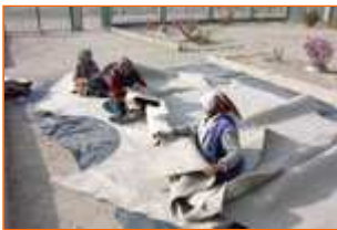
Assemblage de feutre de toit
