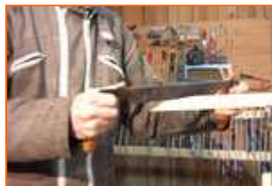
Tenonage d'une perche de toit
