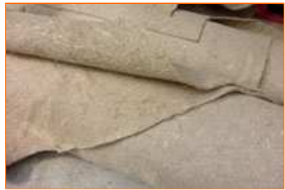
Feutre de chanvre isolant les plateformes
